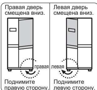
Если холодильник установлен на неровной поверхности или если через несколько дней опоры вдавились в пол под весом продуктов, ровное расположение дверей может быть нарушено. В этом случае отрегулируйте опоры заново.
