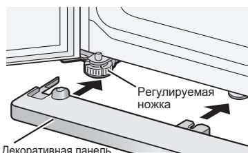
Регулировочные ножки предназначены для выравнивания холодильника по горизонту.
