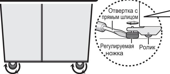
Вставьте Отвертку с прямым шлицом. Проворачивайте регулируемые опоры по часовой стрелке, пока они не коснутся поверхности.
